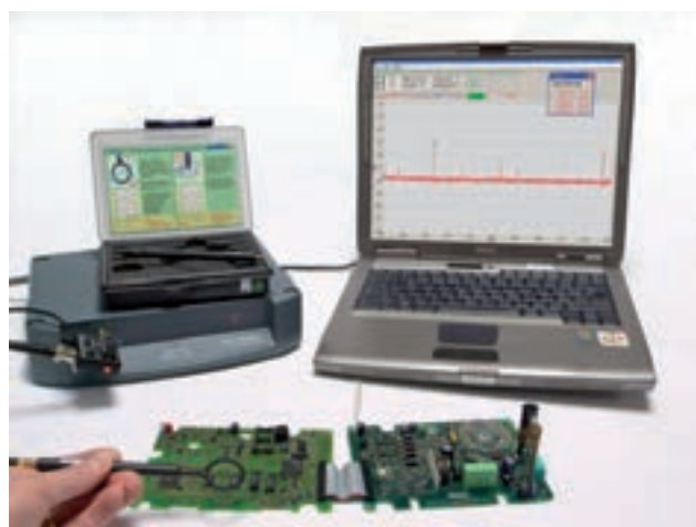
Mesures avec sonde de proximité HX0083 jusqu'à 10 cm de la cible
