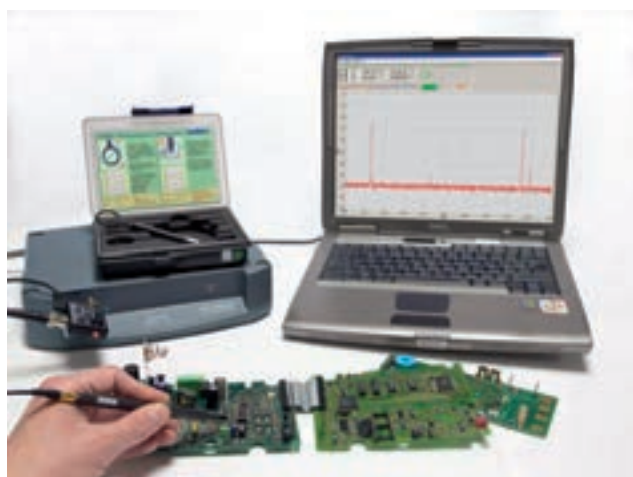
Mesures avec sonde de contact HX0082
